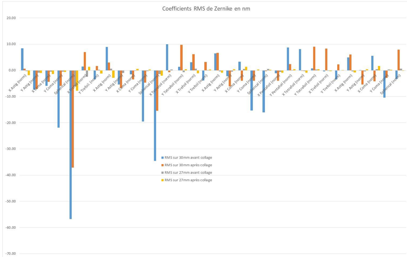
Figure 10 : Coefficients RMS de la décomposition sur les 36 premiers polynômes de Zernike pour M2 avant et après collage.
