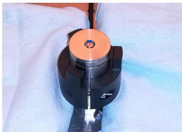
Figure 1 : Actionneur PI avec pièce de centrage (pièce en plastique noire) pour le centrage du miroir M2 sur l'actionneur
