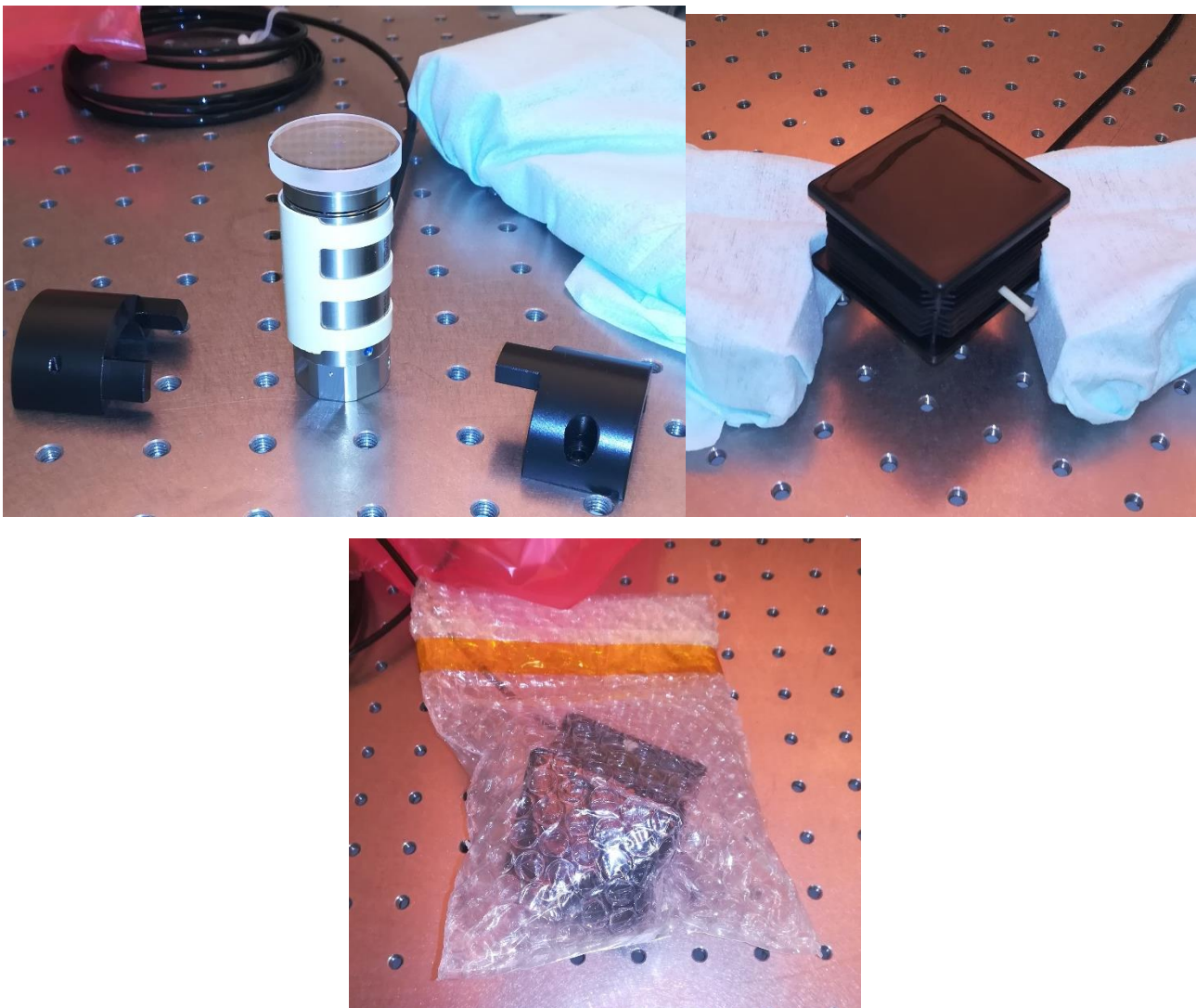
Figure 12 : Emballage des miroirs. En haut à gauche : surépaisseur autour de l'actionneur avant mise en place de la pièce de centrage noire en demi parties ; en haut à droite : mise en place des boîtes rectangulaires ; en bas : actionneur protégé placé dans son sac scellé.
