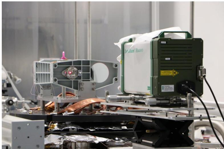
Mesure de la WFE à chaud et à froid d'un télescope en cordiérite
